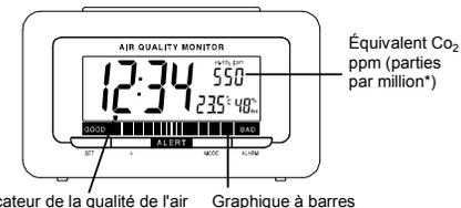
\* L'écart de précision des valeurs mesurées (après l'ajustement du capteur) : +/- 250 ppm.
