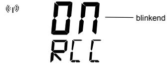
In Gegenden, in denen der Empfang des DCF77-Zeitcodes nicht möglich ist, kann die DCF-Zeitempfangsfunktion abgeschaltet werden (OFF). Die Uhr arbeitet dann wie eine normale Quarzuhr (Voreinstellung EIN).
