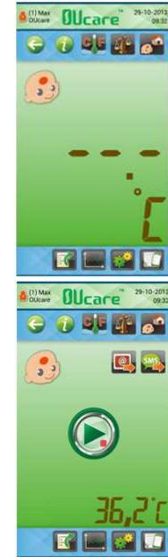
Die gemessene Temperatur wird bei aktivierter Sprachausgabe angesagt. Das Gerät ist jetzt für eine erneute Messung bereit. (Anzeige L/H: Temperatur liegt außerhalb des Messbereichs)
