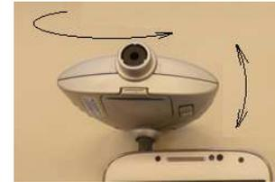
4. Richten Sie den Sensor auf die Stirn. Achten Sie auf einen Abstand des Sensors von 1 bis 3 cm! Die Messzeit beträgt ca. 1 Sekunde. Während der Messung darf der Abstand des Sensors zur Haut nicht verändert werden.
